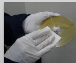
③ ディスクを新しいカートリッジへ入れ替えドライブにより読出しを確認
